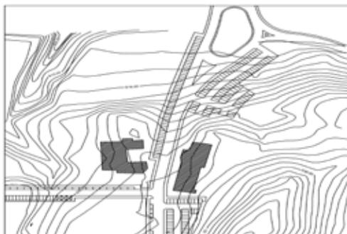
Modificación 3.º Con el fin de evitar la instalación de una estación de bombeo para la red de saneamiento, se ha modificado la rasante del vial A-H en el tramo frente a la manzana M05.
