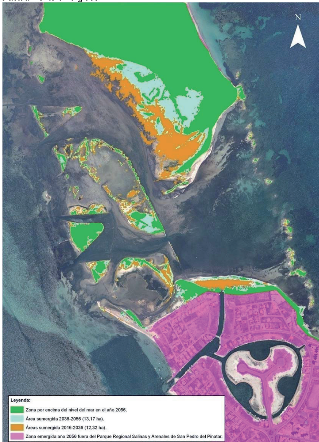
Figura 15. Aplicación de una subida del nivel del mar de 0,5 cm/año a la cartografía topográfica de detalle obtenida a partir del PROYECTO NATMUR-08, promovido por el departamento de medio ambiente de la Administración Regional, concretamente el Modelo Digital del Terreno 4x4 m, como consecuencia del procesamiento de los datos del levantamiento LIDAR.
