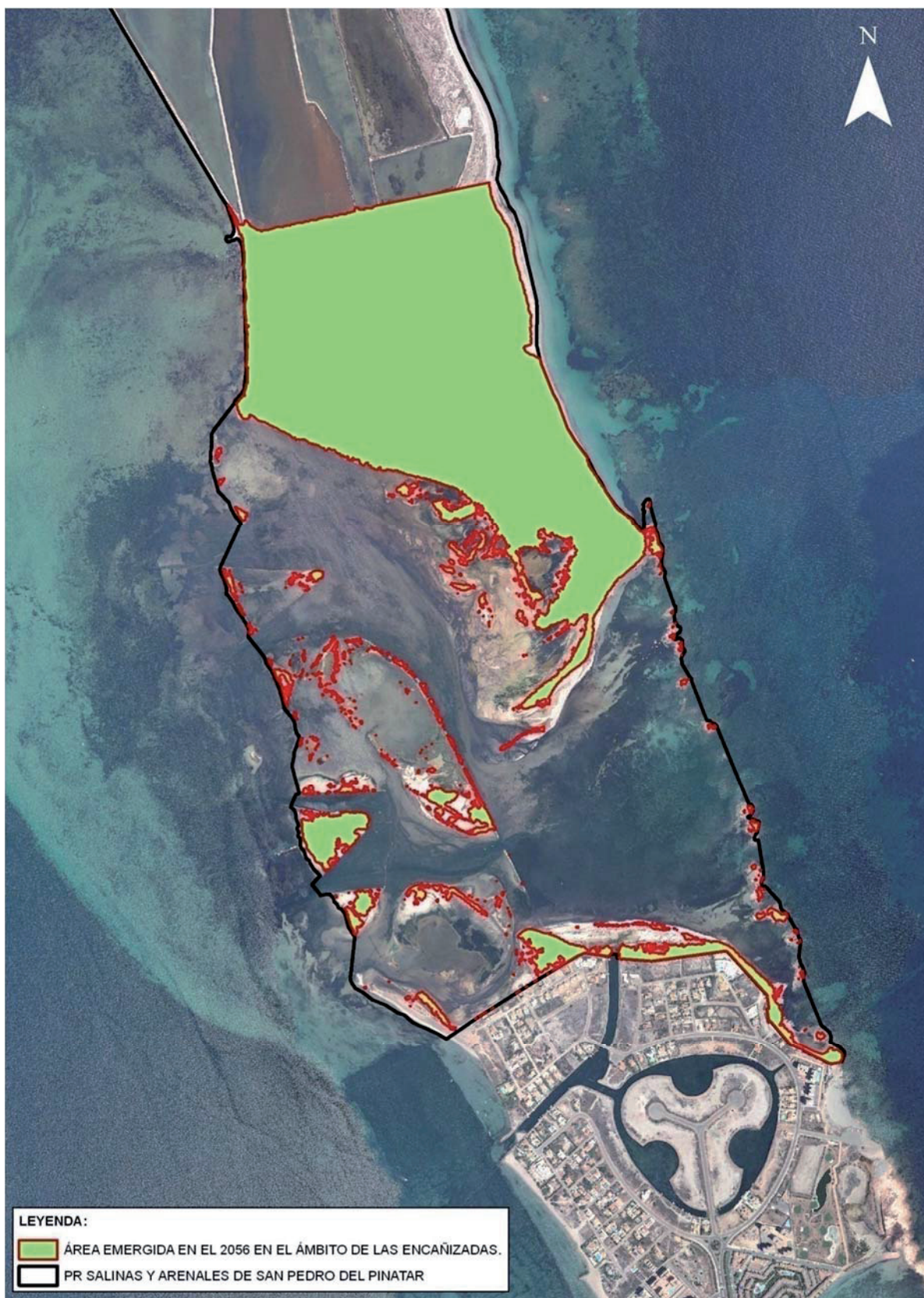
Figura 17. Aplicación de una subida del nivel del mar de 0,5 cm/año a la cartografía topográfica de detalle obtenida a partir del PROYECTO NATMUR-08, promovido por el departamento de medio ambiente de la Administración Regional, concretamente el Modelo Digital del Terreno 4x4 m, como consecuencia del procesamiento de los datos del levantamiento LIDAR.
