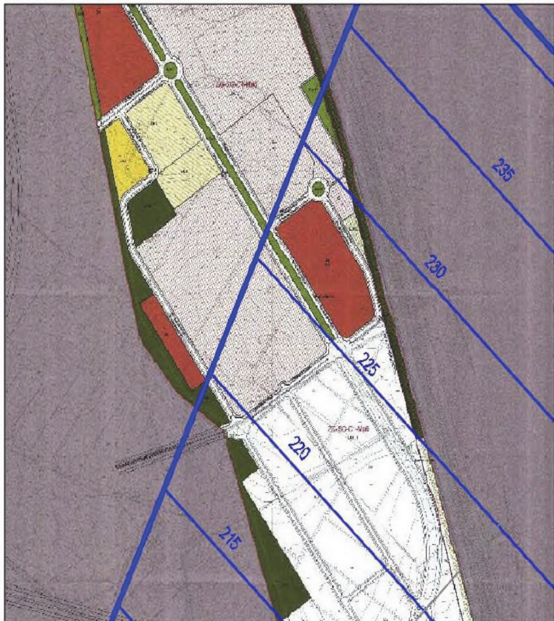
Figura 2. Superficie de Limitación de Alturas del Equipo de trayectoria de planeo del sistema de aterrizaje instrumental contenida en la propuesta de servidumbres aeronáuticas en elaboración
