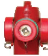
**Sistema Antihelada (Drenaje Automático):** Dispondrá de un dispositivo por el cual, al cerrar la válvula principal, **AUTOMÁTICAMENTE** se abre la válvula de drenaje, permitiendo que el agua de la columna **SE VACIE**, evitándose daños por helada. Con la válvula del hidrante abierta el desagüe queda cerrado.
