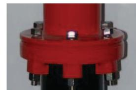
Tendrá las **bocas de salida rectas**, lo cual facilitará la conexión y el uso de mangueras. Los racores estarán protegidos mediante **Tapones de Seguridad antirrobo**, fabricados con carcasa y tapa en plástico-fibra de vidrio, acabados en rojo, núcleo **con cierre en bronce**, **con taponcillo de descompresión** (según UNE 23400) **para facilitar su apertura**, incluyendo gancho fijador al cuerpo. NO estarán permitidas las cadenillas y se abrirán con la misma llave del hidrante (30 mm x 30 mm).
