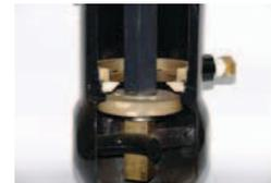
**Sistema de rotura (Rotura conducida) probado según EN 1074-6:2004:** Dispondrá de un dispositivo por el que, ante un fuerte impacto, **romperá** por la unión del cuerpo con el cierre o carrete, **por encima de la válvula** quedando liberado el **obturador se mantendrá automáticamente CERRADO POR LA PROPIA PRESION DEL AGUA**, asegurando su estanqueidad total **sin necesidad de elementos auxiliares o muelles**.
